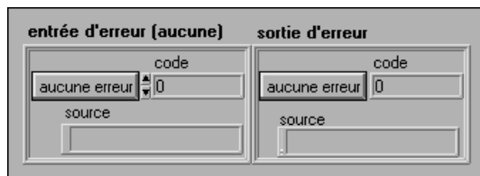
Figure 3-5. Clusters d'erreur Entrée d'erreur et Sortie d'erreur de LabVIEW
